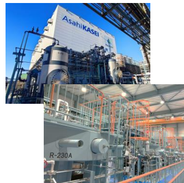
商業機同等サイズの電解槽を用いたパイロットプラントを2設備保有
